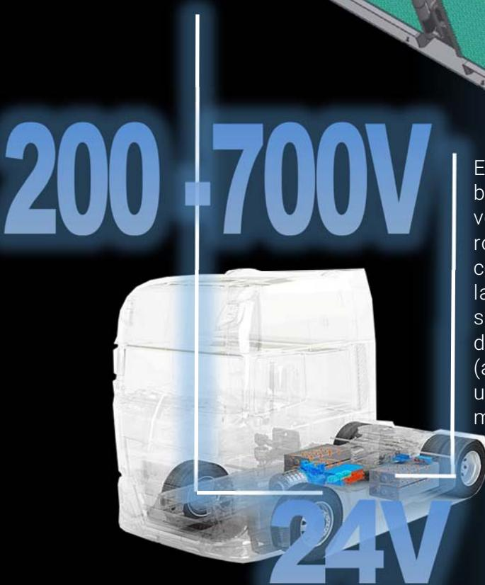
El compresor se alimenta directamente de la batería de tracción de alto voltaje (HV) del vehículo, lo que garantiza un funcionamiento robusto y eficiente, mientras que el circuito de control se alimenta de forma independiente de la batería auxiliar de 24 V para una gestión del sistema fiable y sin problemas. La autonomía del vehículo se ve mínimamente afectada (alrededor del 5 %) por el funcionamiento de la unidad de refrigeración, lo que garantiza la máxima autonomía y eficiencia.
